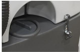
Le réservoir de la solution de nettoyage d'une capacité exceptionnelle de 300 litres et la grande autonomie des batteries assurent une productivité maximale du travail. La grande ouverture arrière permet un remplissage facile et rapide du réservoir de la solution de nettoyage.
