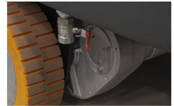
Le motoréducteur, conçu et construit par Lavor, garantit des performances optimales et une fiabilité exceptionnelle (plus de 30 000 heures). Le système innovant à trois roues motrices garantit une traction parfaite dans toutes les situations de travail.
